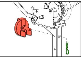
4. STORE THE PULLEY ASSEMBLY ON THE WINCH POST.
